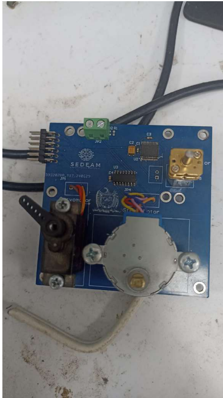
Figura 4.18: Primera versión de la PCB: distribución preliminar de componentes.
