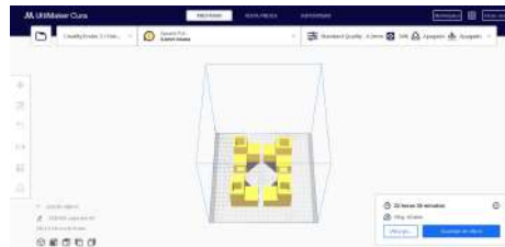
Figura 4.14: Coples superiores impresos para ensamblaje modular.
