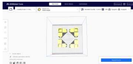
Figura 4.15: Coples inferiores impresos para unión de perfiles.
