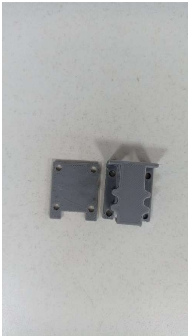
Figura 4.11: Carcasa impresa para el módulo conjunto de Basys 3 y PCB.
