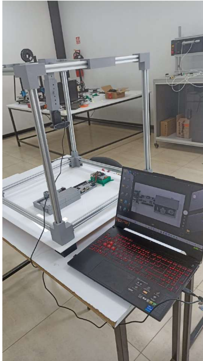
Figura 4.21: Prueba funcional del laboratorio remoto con visualización desde la computadora del usuario.
