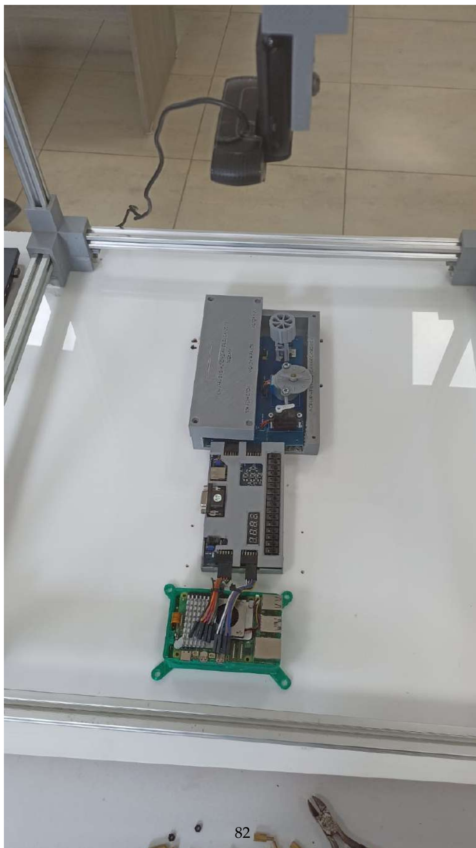
Figura 4.13: Vista general del laboratorio ensamblado con Raspberry Pi, Basys 3 y cámara.
