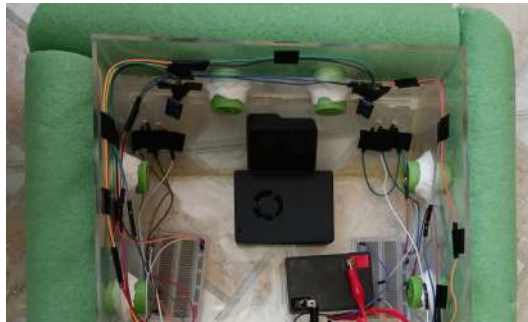
Figura 7.3: Cámara GoPro y Raspberry Pi integrados a la estructura del robot.
