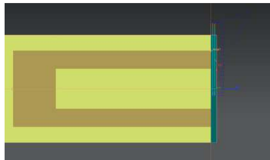
Figura 6.12: Resultado esperado después del careado del material.
