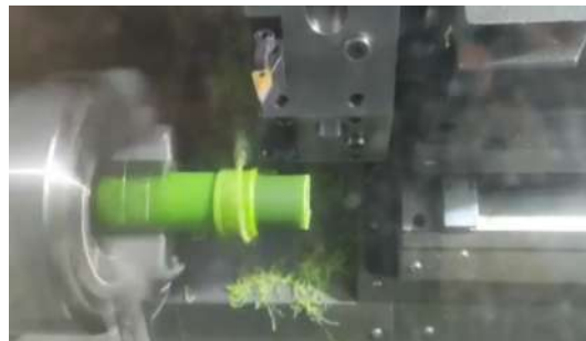
Figura 6.17: Manufactura en torno CNC de los soportes.
