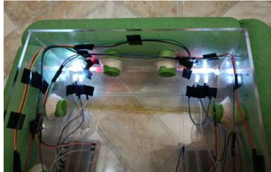
Figura 7.1: Sensores de iluminación y LEDs integrados a la estructura del robot.
