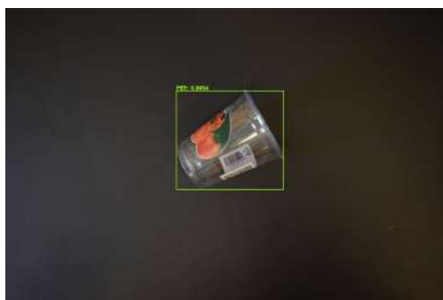
Figura 8.11: Objeto tipo PET detectado correctamente con la arquitectura YOLOv4 y pesos de 5000 iteraciones.
