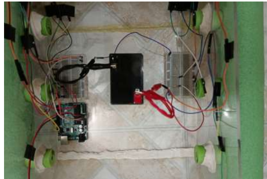
Figura 7.2: Arduino, batería y protoboards integrados a la estructura del robot.
