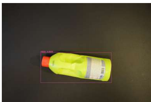
Figura 8.10: Objeto tipo PEHD detectado correctamente con la arquitectura YOLOv4 y pesos de 3000 iteraciones.
