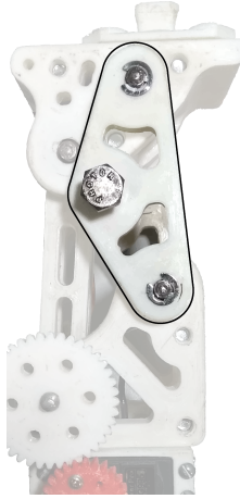
Figura 5.20: Tornillo que ajusta el sistema de bloqueo.
