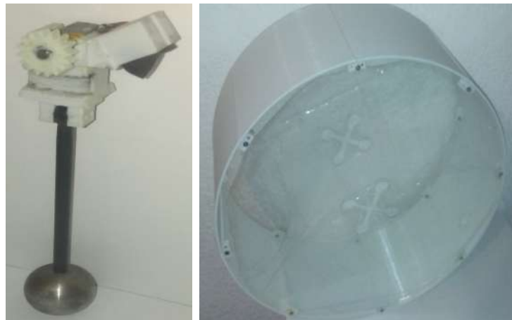
(a) Ensamble péndulo, base pendulo, acrílico y PLA. porta carbones y piñón.
