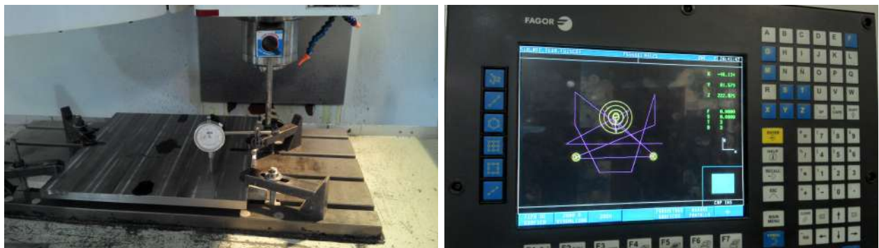
Figura 3.25: Calibración del posicionamiento de la placa (izquierda) y simulación del proceso de maquinado CNC (derecha).
