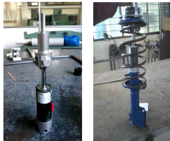
Figura 6 – Sistema de suspensión acoplada con el amortiguador MR RD 8040-1 de Lord Corporation®.
