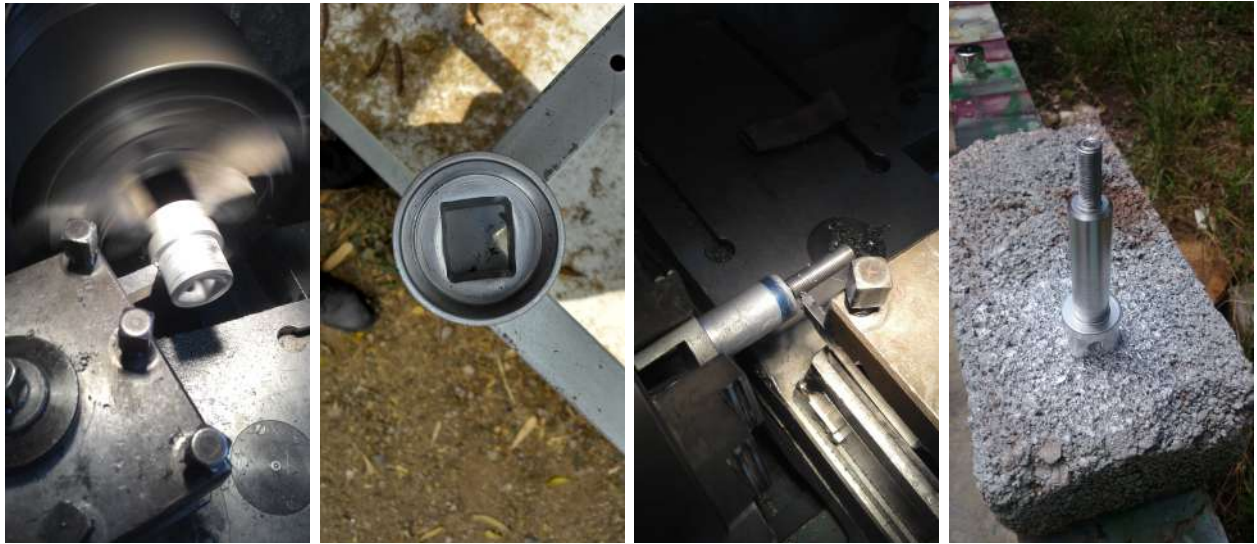
Figura 3.18: Manufactura de los soportes inferior (primera, segunda) y superior (tercera, cuarta) del amortiguador: torneado y acabados. El orificio rectangular del soporte inferior tiene la finalidad de limitar la rotación del amortiguador. El soporte superior cuenta con un roscado métrico fino exterior M12x1.75 para el ensamble de la suspensión.
