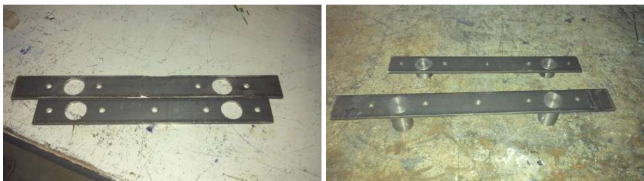
Figura 3.27: Sujetadores de las guías lineales: soleras resultantes del maquinado CNC (izquierda) y bujes de calibración del posicionamiento paralelo de las guías (derecha).
