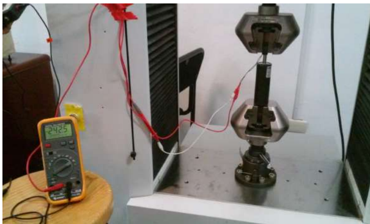
Figura 4.4: Recolección de datos de Fuerza-Desplazamiento.
