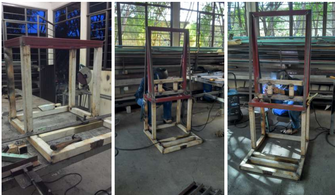
Figura 3.21: Soldadura de la estructura de soporte: base para el sistema de perturbación (izquierda); sección superior (marco) para el sistema de guiado acoplada a la base con miembros angulares como tensores (medio y derecha).
