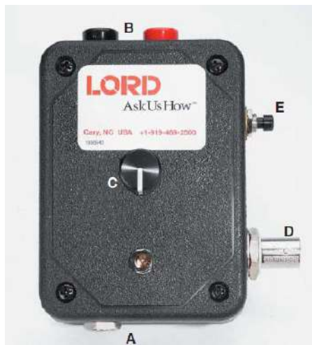
Figura 4.1: Convertidor V-I LORD Wonder Box ® de LORD Corporation ® .
