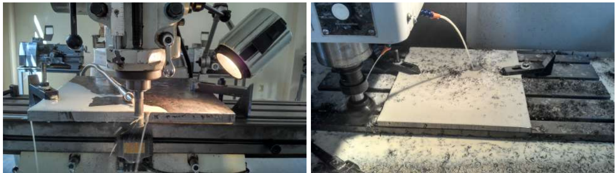
Figura 3.24: Rectificación lateral (izquierda) y de las caras superior e inferior (derecha) de la placa masa acero A36 40x40cm de \frac{1}{4} in de grosor.
