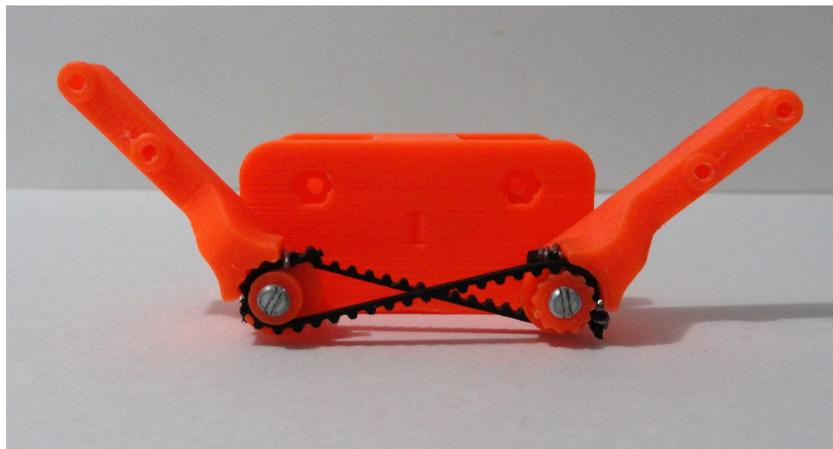
Figura 3.26: Colocación de bandas síncronas en los eslabones.
