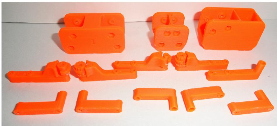
Figura 3.24: *Piezas impresas en 3D para el exoesqueleto del dedo índice.*
