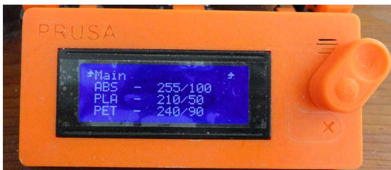
Figura 3.21: *Temperaturas de precalentado para los materiales de impresión 3D en la impresora Prusa i3.*
