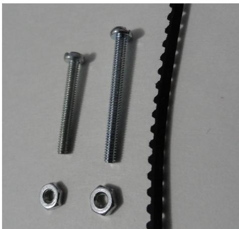
Figura 3.25: Tornillos  $M2 \times 0.40$  y banda síncrona con paso de 2mm.
