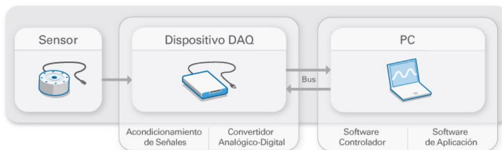
Figura 2.18: *Partes de un sistema DAQ* [45].
