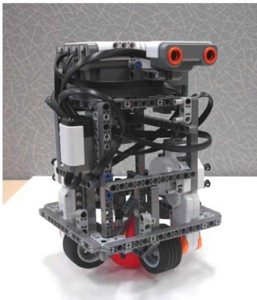
Figura 1.11: Prototipo NXT ballbot desarrollado por Yorihsa Yamamoto y basado en el ballbot de Ralph Hollis. Imagen tomada de [78].
