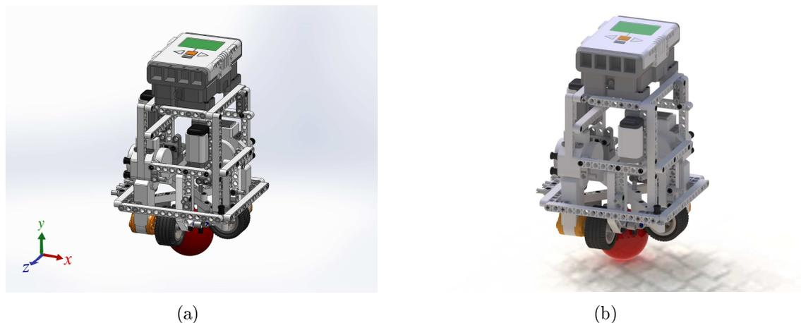
Figura 3.16: (a) Modelo completo del NXT ballbot en 3D diseñado en *Solidworks*<sup>®</sup>; (b) Render del modelo NXT ballbot en *Solidworks*<sup>®</sup>.
