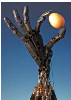
Figura 1.3: Prótesis neumática Shadow<sup>®</sup> [11].
