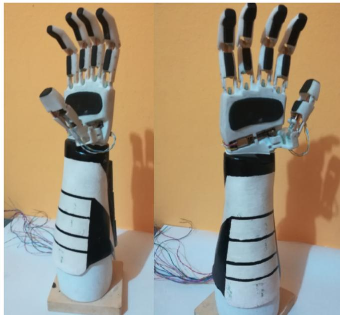
Figura 3.21: Prótesis ensamblada.
