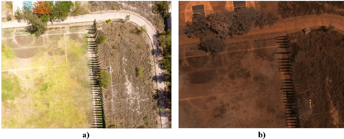
Figura 4. a) Imagen a color de alta resolución capturada por la cámara del Phantom 4, b) imagen NIR capturada por el NDVI Single Sensor de la compañía Sentera.
