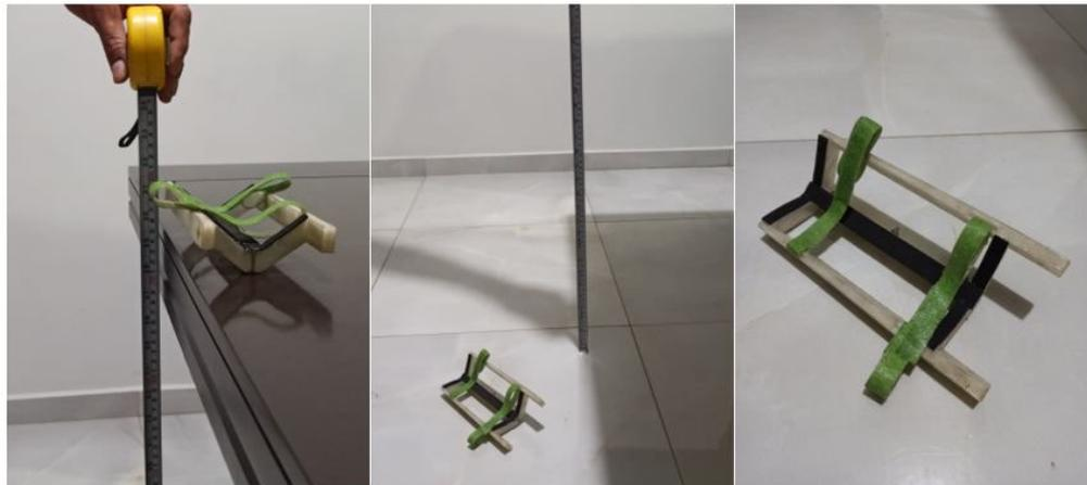
Figura 13. Prueba de caída para el soporte de antebrazo a) altura al nivel de una mesa, b) caída al nivel del suelo y c) verificación de no existir fractura.
