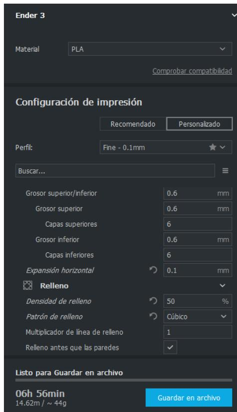
Figura 10. Parámetros de impresión generales para la mitad del soporte del antebrazo en software Cura.
