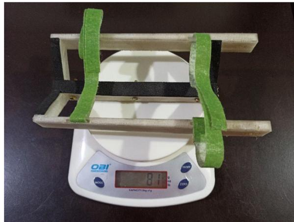
**Figura 15. Medición de masa del soporte para antebrazo del robot para rehabilitación.**
