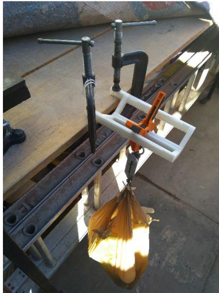
Figura 12. Prueba de carga estática en el soporte para antebrazo.
