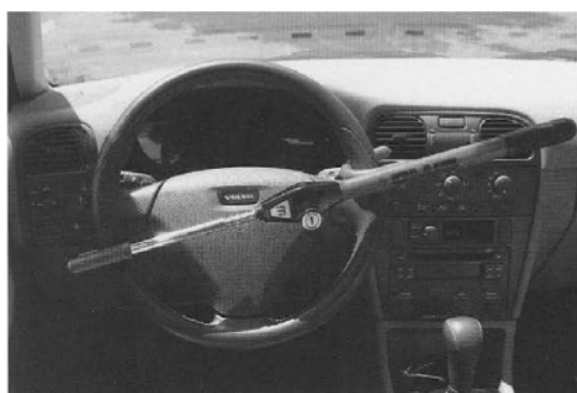
Figura 2. Inmovilizador mecánico de volante [3]
