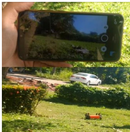
Figura 29. Visión en tiempo real del robot con conexión Wi-Fi. [15]
