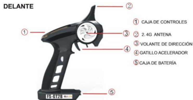
Figura 22. Partes del radiocontrol.
