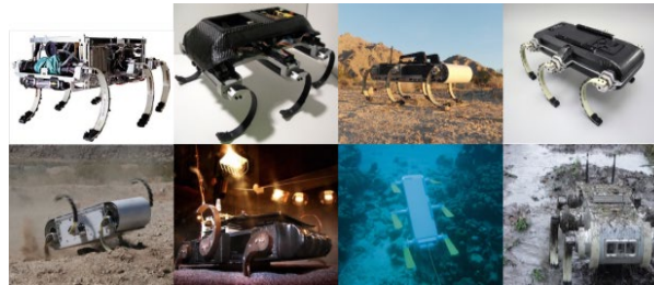
Figura 8. Las ocho versiones del robot RHex. [13]
