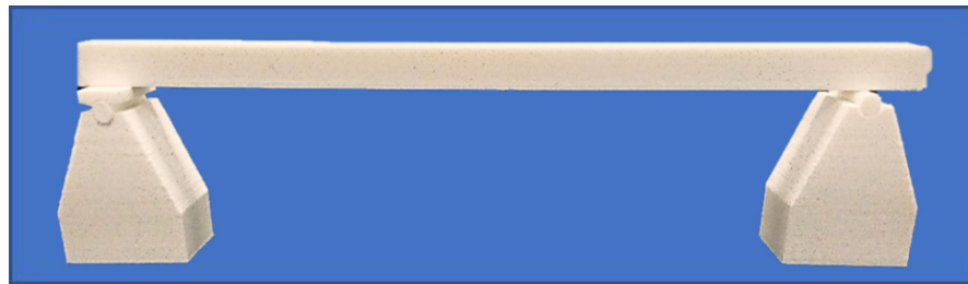
Figura 6. Viga isoestática para el estudio de la deflexión.
