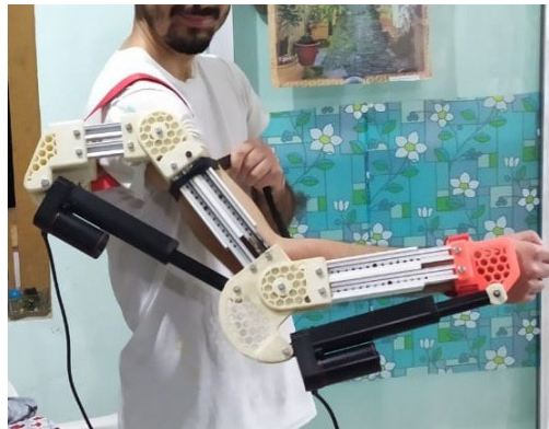
Figura 12. Movimiento de abducción/aducción del exoesqueleto en hombro.
