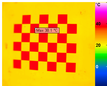
Figura 2. Imagen térmica del patrón de calibración.
