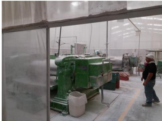
**Figura 5. Molinos mezcladores tipo rodillos**
