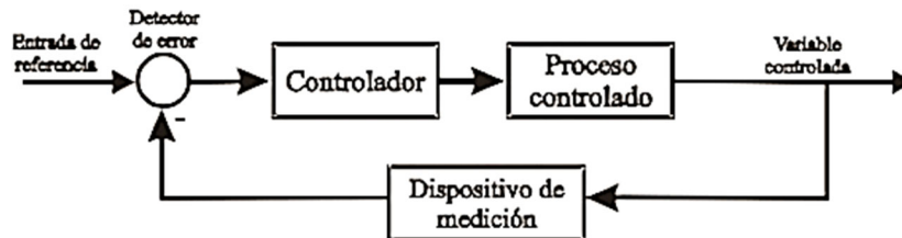
Figura 2. Diagrama de un sistema de control de lazo cerrado [8]
