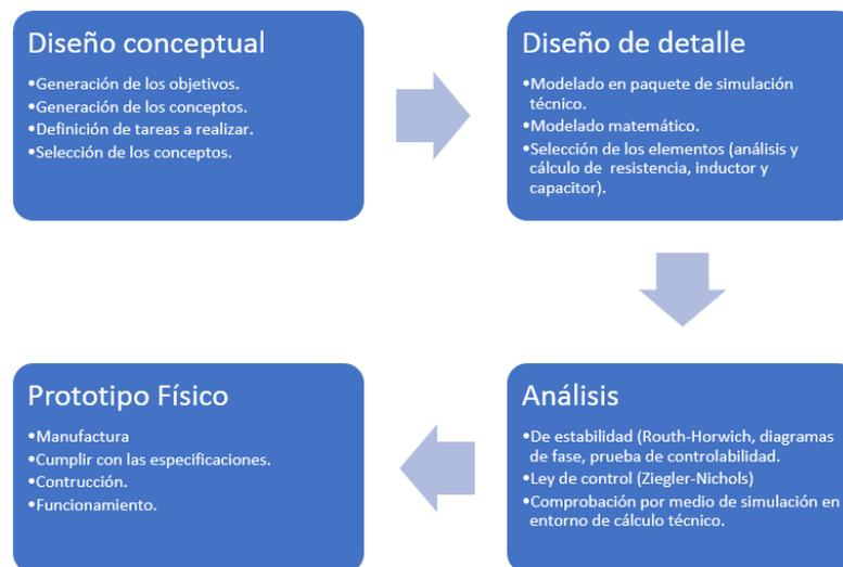
Figura 1. Pasos para de modelación, simulación y análisis del convertidor Buck-Boost (Ulrich, 2004).
