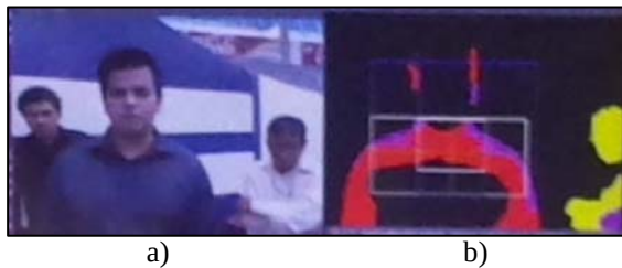
Fig. 3. Ejemplo de la ejecución del sistema visual de seguimiento: a) imagen original, b) segmentación y localización del usuario.
