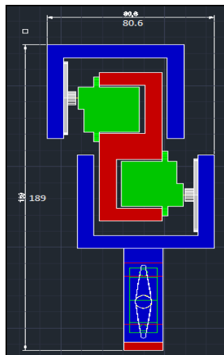
Fig. 7. Diseño de la pierna del robot bípedo
