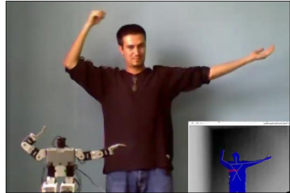
Fig. 9(a). Robot Bioloid replicando movimientos de brazos
