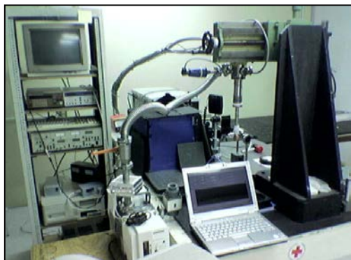
Figura 9. Imagen del sistema de fotoluminiscencia donde se aprecia la interfaz de usuario en programación visual.
