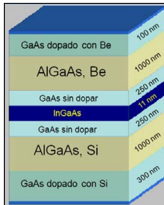
Figura 2. Ilustración de una heteroestructura láser de pozo cuántico.
