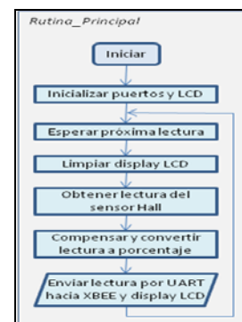
Fig. 10. Diagrama a bloques del software embebido en el transmisor
