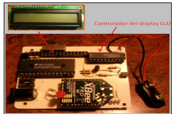
Fig. 9. Diseño del receptor para el prototipo
