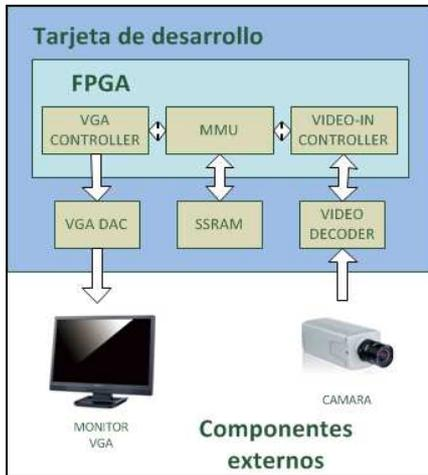
Fig. 1 Diagrama a bloques del sistema.
