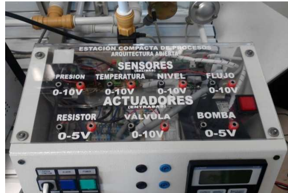
Fig. 10 Estación compacta de procesos en arquitectura abierta
