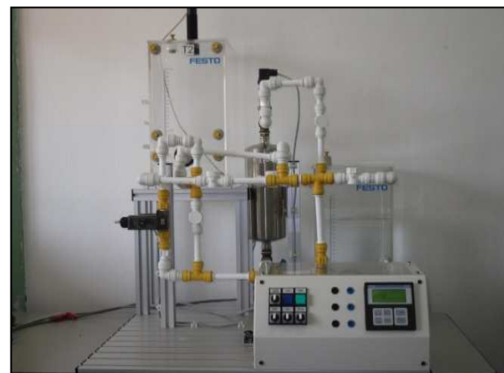
Fig. 1 Estación Compacta de Procesos (ECP)
