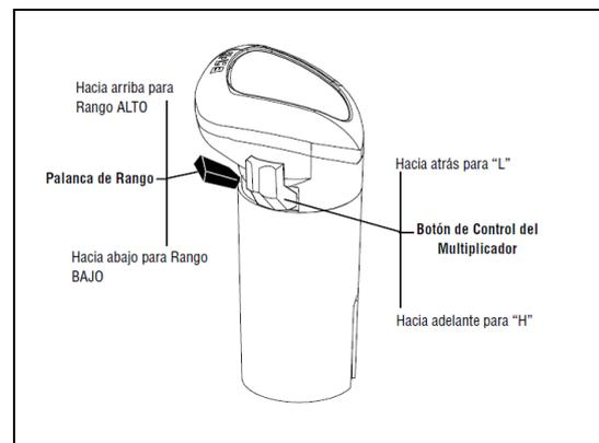
**Fig. 1. Palanca de cambios [?]**
