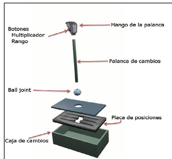
Fig. 3. Diseño mecánico de la palanca de cambios.
