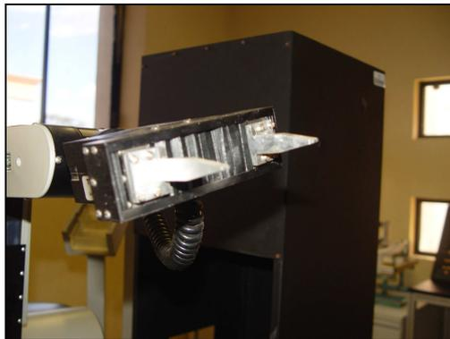
Fig. 2.4 Pinza sujetadora instalada
