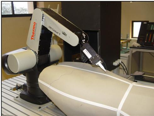
**Fig. 3.1 Posicionamiento de Brazo CRS5 para inicio de proceso de suturación**
