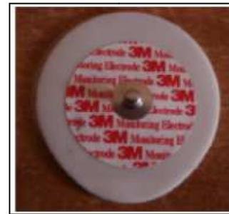
Fig. 4. Electrodo superficial con gel de tipo comercial
