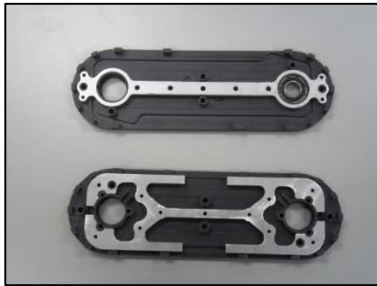
Fig. 15. Estructuras principales del primer eslabón.
