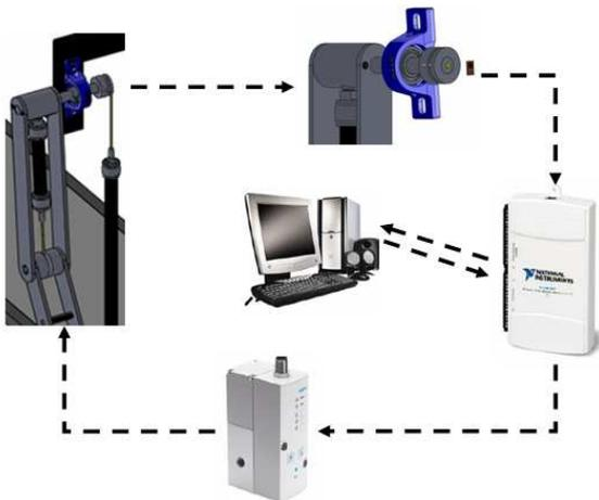
Figura 14. Flujo de señales para el control.
