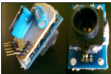
Fig. 4. Sistema completo de reconocimiento de colores mediante red neuronal artificial.
