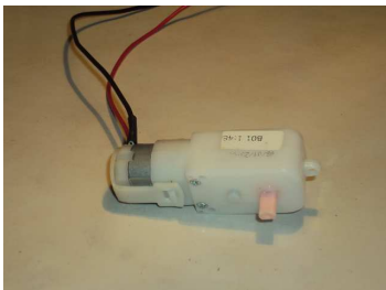
Fig. 2 Motoreductor propuesto para la movilidad del minirobot
