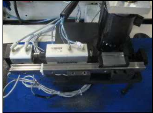
Figura 3: Sistema mecánico para el cambio de posiciones del deslizador de la perilla.
