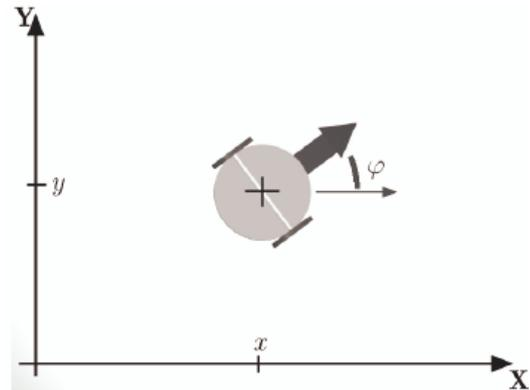
Figura 4: variables de la posición absoluta del robot
