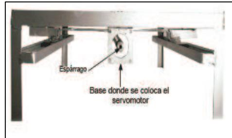
Figura 3. Eje X montado bajo el bastidor.
