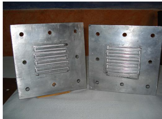
Figura 9. Celda de Combustible tipo PEM.
