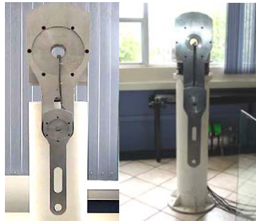
Fig. 1 Robot manipulador de transmisión directa de 3 grados de libertad.
