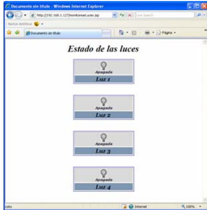
Figura 9. Monitorear el estado de las luces desde un navegador web.
