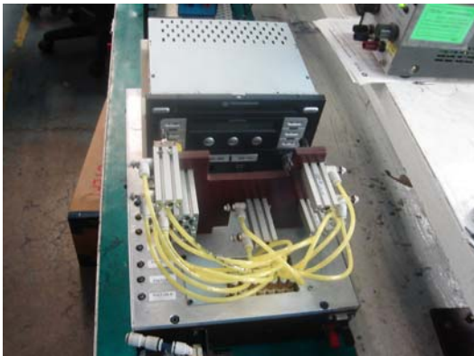
Fig. 5.- Vista frontal del montaje de pistones en relación con el auto estéreo.
