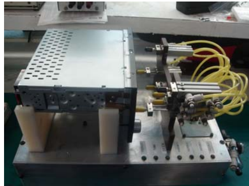
Fig. 6.- Jig terminado con un auto estéreo montado para programación.
