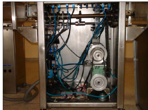
Fig. 1 Sistema semiautomático de control de sopleteado.
