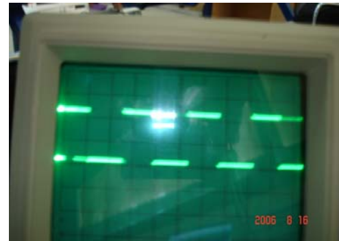
Fig. 13. Señal de 3 KHz para modular el '0' lógico.
