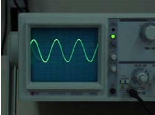
Fig. 14. Señal de 1 KHz demodulada y amplificada.
