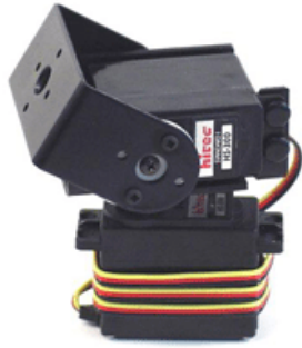
Fig. 2. Unión Robótica de dos grados de libertad para la cámara web.
