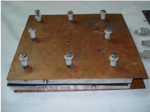
Figura 8. Celda de combustible tipo PEM
