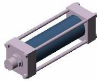
Fig. 3.6: Diseño en AutoCad del pistón que proporcionará el movimiento lineal.
