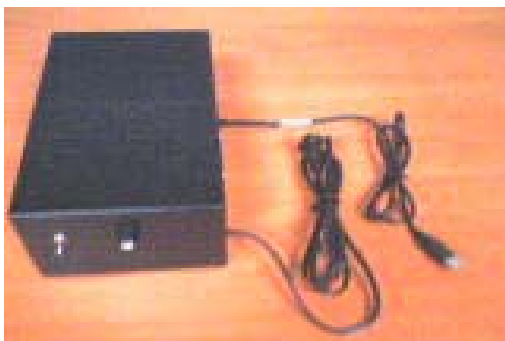
Fig. 3.2. Dispositivo construido del controlador de temperatura con rampa de calentamiento.
