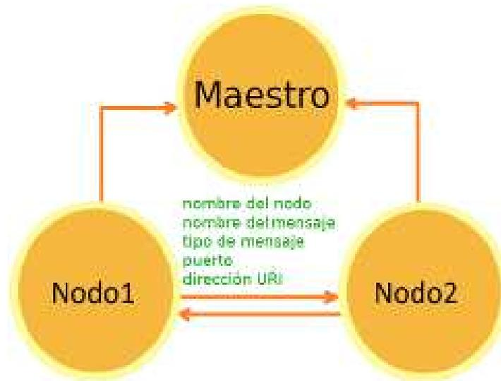
**Figura 2. Conexión entre nodos.**
