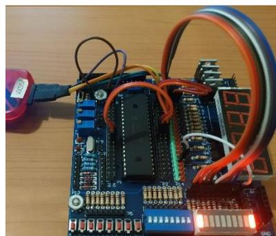
**Figura 19. Conexiones del microcontrolador hacia los leds.**
