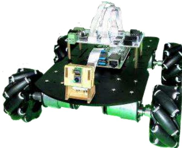
**Figura 10. Ensamble del robot móvil.**
