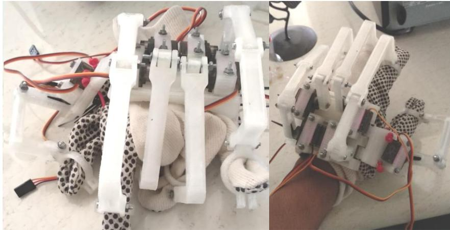
**Figura 9. Órtesis con los servomotores ya montados.**
