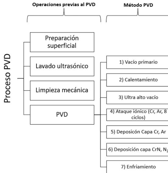
**Figura 4, diagrama de bloques en donde se enlista la secuencia de pasos para llevar a cabo un procesamiento del tipo PVD para obtener un recubrimiento Cr + CrN.**
