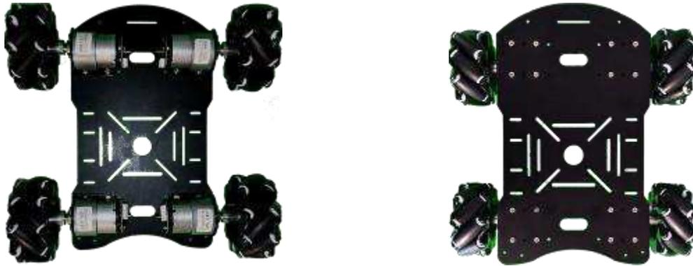
**Figura 9. Vista inferior y superior de izquierda a derecha respectivamente de la base de nuestro robot móvil.**
