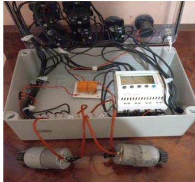
**Figura 10. Prueba de voltaje del motor mediante la variación del voltaje de entrada con un potenciómetro.**
