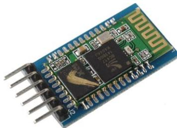
**Figura 11. Antena Bluetooth para Arduino**
