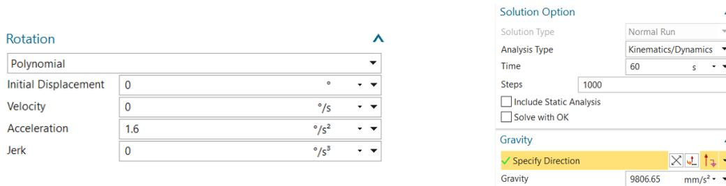
**Figura 13. Definición de la velocidad de entrada del sistema de engranes y tiempo de ejecución de la simulación.**
