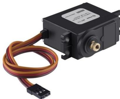
**Figura 8. Ilustración de un servo motor y sus puntas de conexión**
