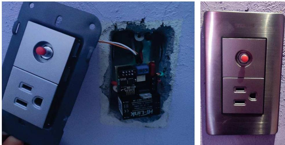
Figura 10. Instalación del interruptor inalámbrico Wi-Fi.
