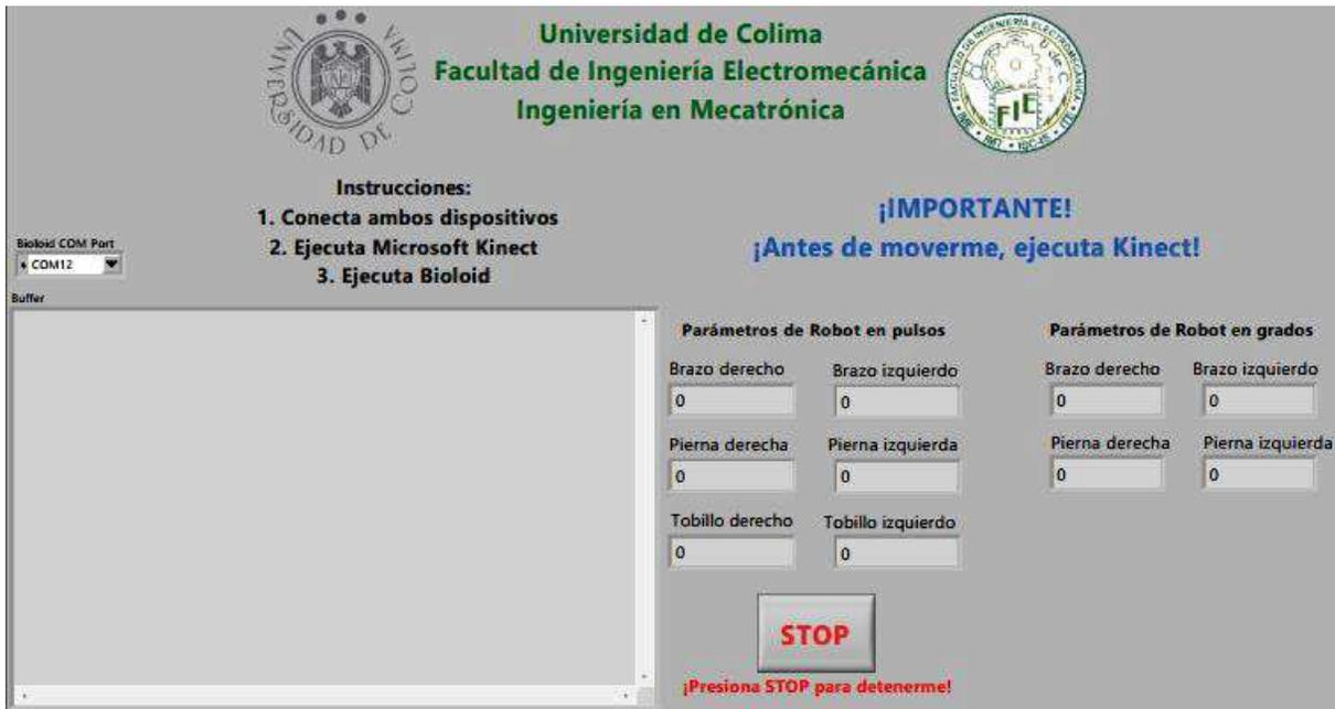
Figura 24. Interfaz de control para las extremidades del robot humanoide.
