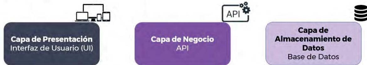
Figura 2. Capas involucradas en un programa de software.
