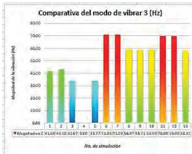
Figura 15. Gráfica que muestra el tercer modo de vibrar de la estructura de menor rigidez.
