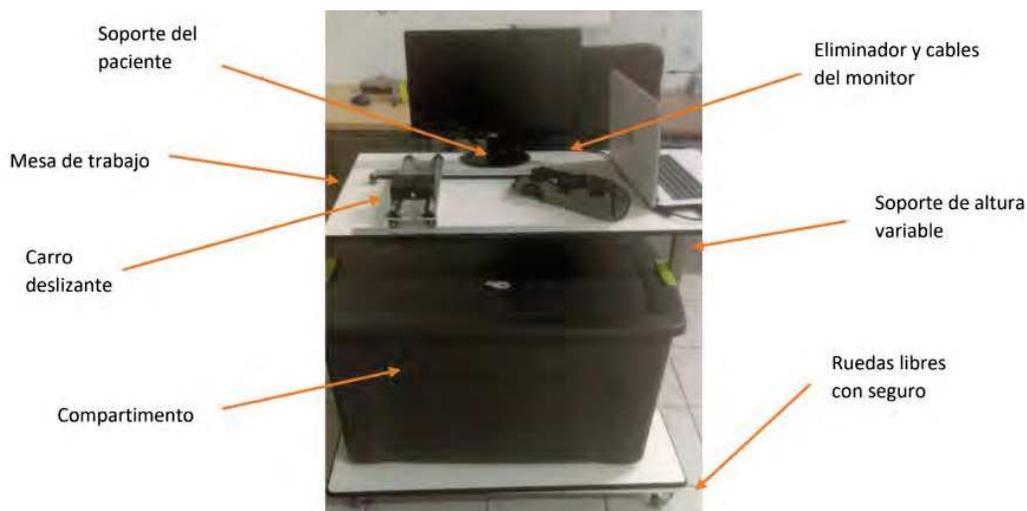
Figura 10. Partes del dispositivo final.
