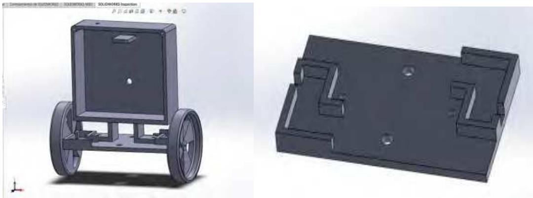
Figura 7.- Diseño en 3D de la estructura del segundo robot balancín.
