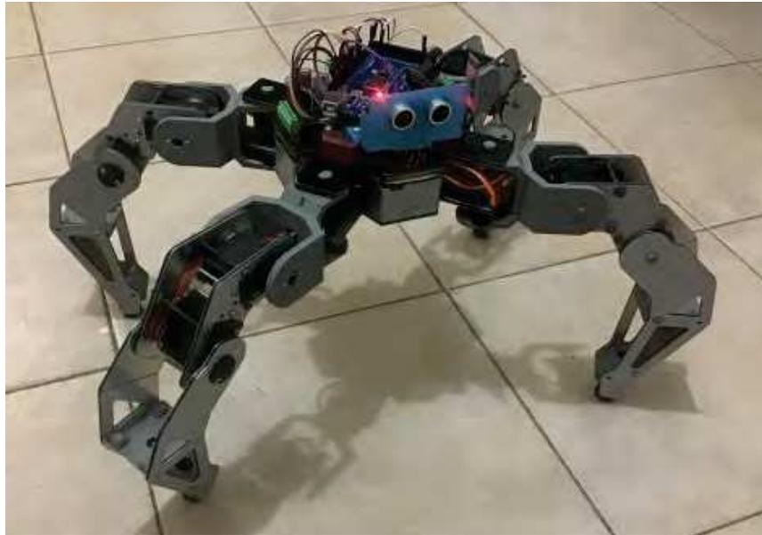
Figura 11. Cuadrúpedo ensamblado.
