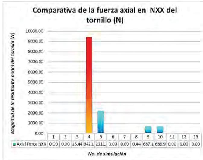
Figura 11. Gráfica que muestra la fuerza axial a la que están sometidos los tornillos de la estructura de menor rigidez.
