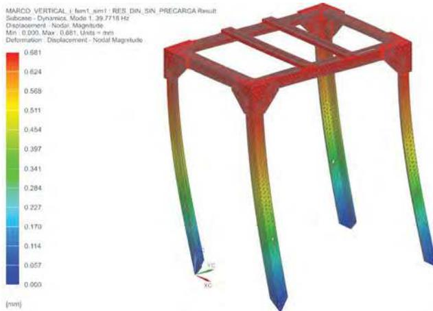
Figura 6. Corrida en modo Respuesta Dinámica, con cargas.
