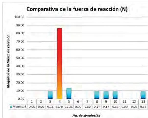
Figura 8. Gráfica que muestra la fuerza de reacción de la estructura de menor rigidez.
