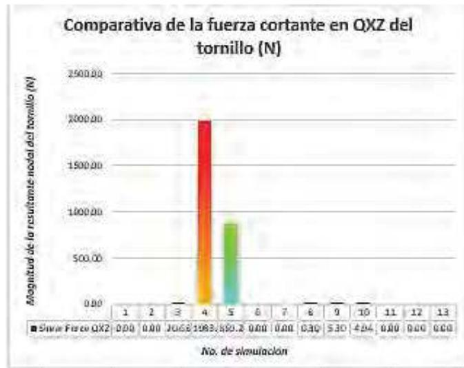
Figura 12. Gráfica que muestra fuerza cortante a la que están sometidos los tornillos de la estructura de menor rigidez.
