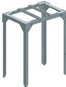
**Figura 3. Representación gráfica de la estructura metálica de 1 GDL con baja rigidez.**
