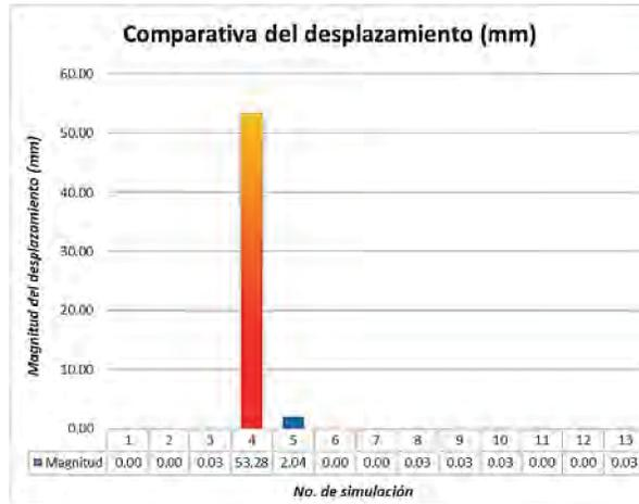
Figura 7. Gráfica que muestra el desplazamiento total de la estructura de menor rigidez.
