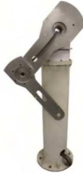
Figura 4. Robot manipulador de 2 grados de libertad.
