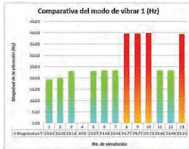
Figura 13. Gráfica que muestra el primer modo de vibrar de la estructura de menor rigidez.
