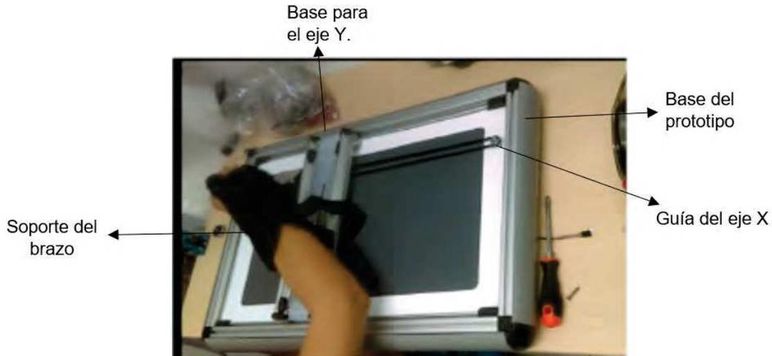
Figura 3. Primer prototipo del plano X,Z completo.
