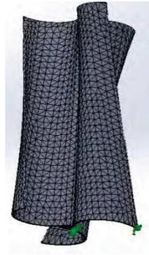
**Figura 4. Discretización de la turbina helicoidal de eje vertical.**
