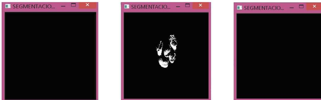
**Figura 18 Segmentación con 10 horas de secado. De izquierda a derecha: máscaras verde, roja y azul.**
