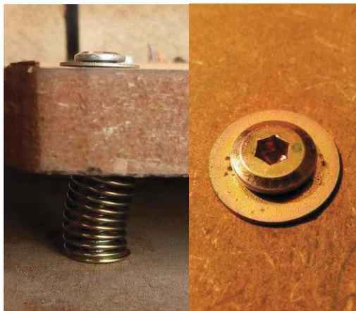
**Figura 42. Mecanismo de ajuste de altura**
