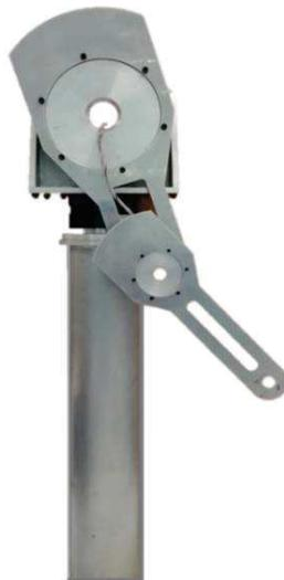
**Figura 1. Robot manipulador de transmisión directa de dos grados de libertad**
