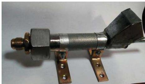
Figura 43. Prototipo de extrusor.
