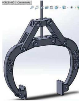
Figura 6. Efector final para el robot neumático.
