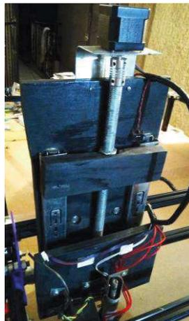
Figura 39. Base del eje Z
