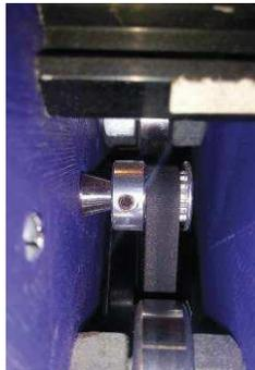
Figura 36. Transmisión por banda y polea.
