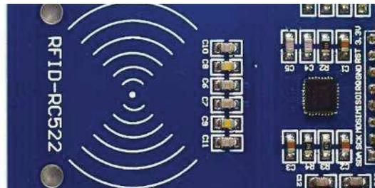
**Figura 1.4.** Módulo RFID.
