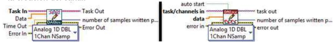
Figura 9. Función para leer un canal (Izquierda: ISE-LabVIEW©, Derecha: DAQmx).
