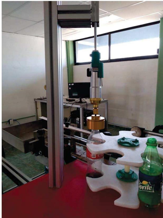
Figura 13 Cilindro neumático y taponadora neumática acoplados a la base del carrusel.
