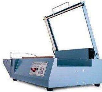
**Figura 6. Máquina selladora tipo L**
