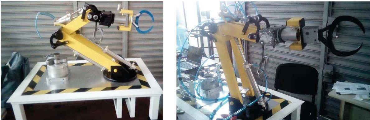
Figura 12. Robot neumático de 6 grados de libertad.
