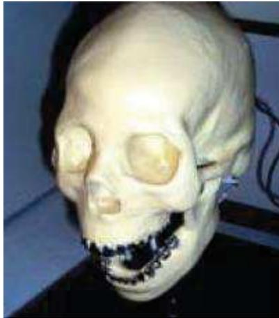
**Figura 2. Simulador de movimientos mandibulares [4].**
