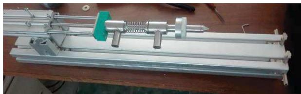
**Figura 12 Válvula llenadora montada al soporte de aluminio.**
