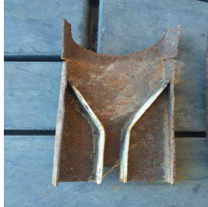
Figura 7. Rampa de caída.
